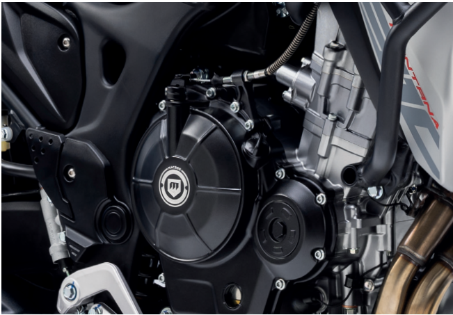
BICYLINDRE, 4 TEMPS, 8 SOUPAPES, 498 CC, 47 CV
