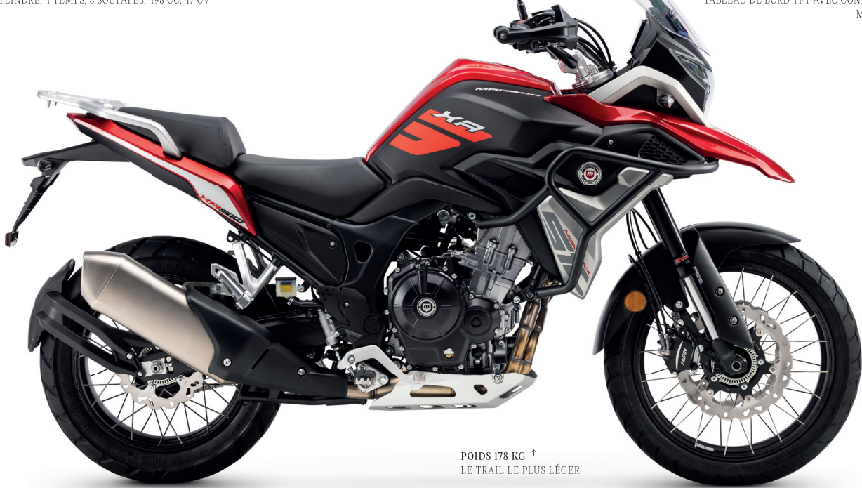
BICYLINDRE, 4 TEMPS, 8 SOUPAPES, 498 CC, 47 CV
