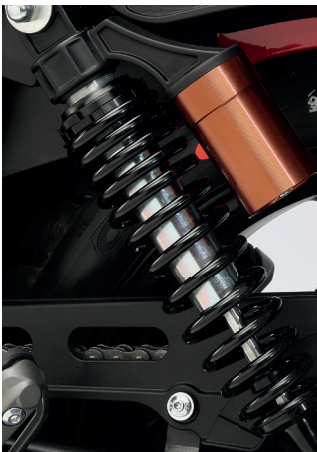
DOUBLE AMORTISSEUR AVEC RÉSERVOIR À GAZ SÉPARÉ
