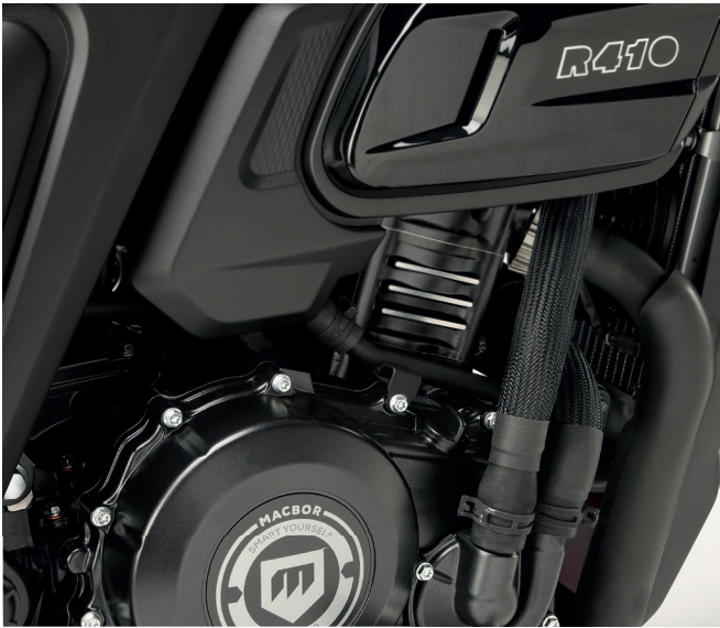
MOTEUR BICYLINDRE, 4 TEMPS, DOHC 8 SOUPAPES, 42 CV, REFROIDISSEMENT LIQUIDE
